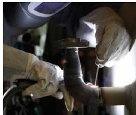
Le Focus TIG 200 DC HP est fourni avec des électrodes tungstène MIGA Super Blue, qui présentent d'excellentes propriétés d'amorçage/de réamorçage et sont utilisables avec tous types de matériaux.
